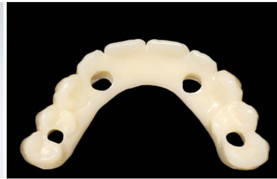
Abb. 17: Das Sofortprovisorium wurde aus hochleistungsfähigem PMMA gefräst und die Bereiche um die Titankappen großzügig freigeschliffen.
