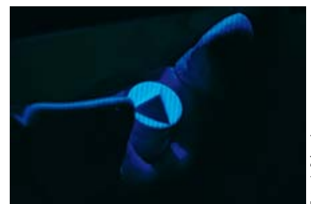
Abbildung 6: Digitalisierung des Meistermodells mittels Streifenlichtscanners
