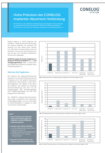
Abb. 2: Präzision verschiedener konischer Verbindungen: siehe WhitepaperM-0154-WPR-DACH-BHCL-00-022021.
