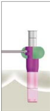
Kunststoffverbindung mit Transferspinne im Parallelometer
