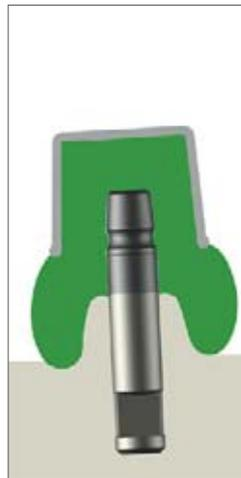
Nach dem Aushärten des Modellmaterials und Entfernen des Abdrucks verbleiben die Abformpfosten für Stegaufbau auf den Lötihilfe/Steg-Laborimplantaten. Die Abformpfosten werden von den Lötihilfe/Steg-Laborimplantaten abgeschraubt. Entsprechend der Planung erfolgt die Stegherstellung mit den vorgesehenen Stegbasen.
