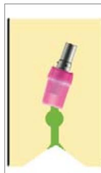
Die Einbettmasse muss auf die angussfähige Legierung und die verwendete Angusslegierung abgestimmt sein. Wir empfehlen phosphatgebundene Einbettmassen. Die Verarbeitungsanweisungen der Hersteller müssen beachtet, die Mischungsverhältnisse und Vorwärmzeiten exakt eingehalten werden. Wir empfehlen keine Schnellerhitzungsverfahren (Speed-Einbettmassen) zu verwenden. Die Gussverzugszeit muss so kurz wie möglich gehalten werden.
